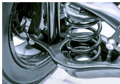
Hochduktiler mikrolegierter Stahl für Fahrwerksteile der Radaufhängung.
